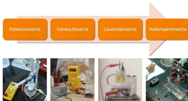
Figura 1. Niveles en la enseñanza experimental de la electroquímica analítica. De izquierda a derecha: Potenciometría (equilibrio en la interfase metal – disolución); conductimetría (fenómenos de migración iónica); coulombimetría (reacción electroquímica mediadas por las leyes de Faraday); voltamperometría (técnicas electroquímicas y casos específicos).
