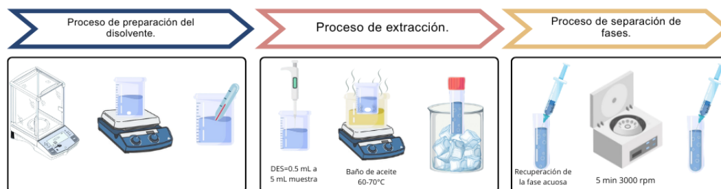
Figura 1: Metodología empleada para el proceso de extracción de cobre.
