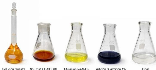
Figura 1. Secuencia del procedimiento de valoración yodométrica indirecta para la determinación de \text{Fe}^{3+} en la muestra.
